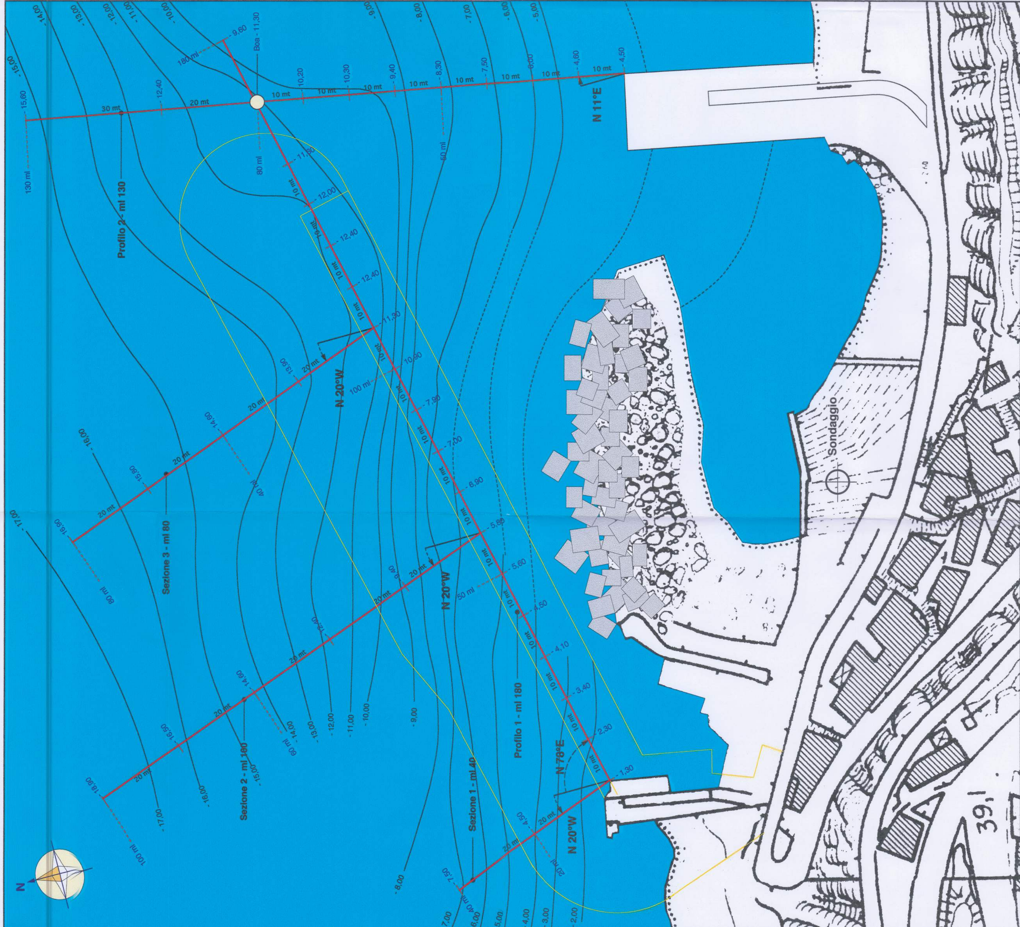
SCALO GALERA Rilievo batimetrico Scala 1/500
